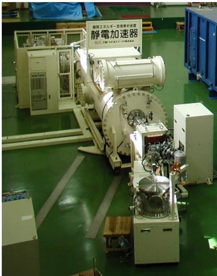
شکل (۲) تصویر شتابدهنده یونی و ابزارهای RBS [۳].
